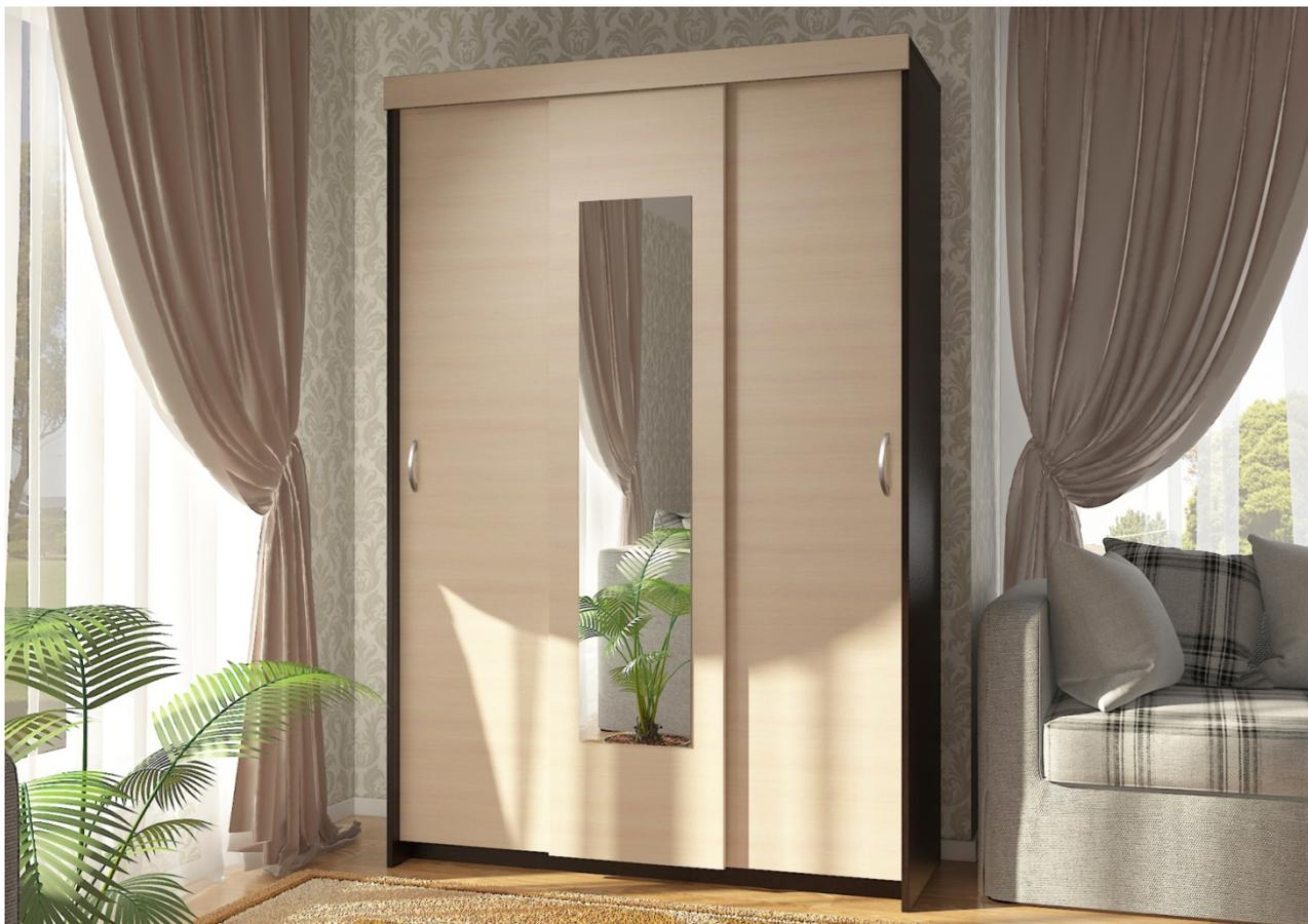
Каркас и фасад **Комфорт 9 М Шкаф-купе** выполнены из ЛДСП 16мм. Торцы деталей закрашены кромкой ПВХ толщиной 0,4 мм. Задние стенки выполнены из ДВП толщиной 3,2мм.
