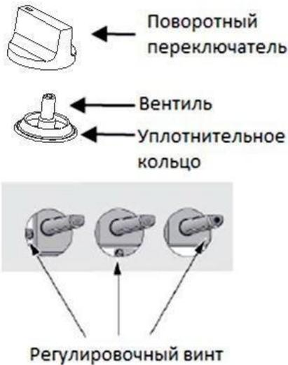
Эта регулировка производится после замены жиклеров или при необходимости.
