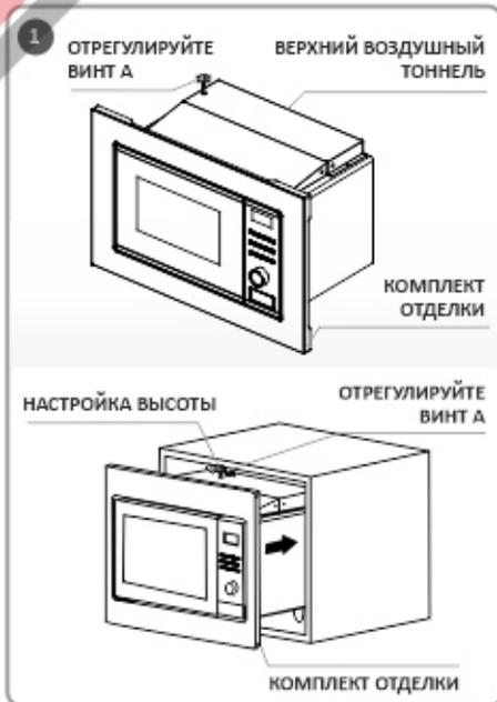
1. Закрепите РЕГУЛИРУЮЩИЙ ВИНТ А на ВЕРХНЕМ ВОЗДУШНОМ ТУННЕЛЕ микроволновки, а затем установить прибор.
